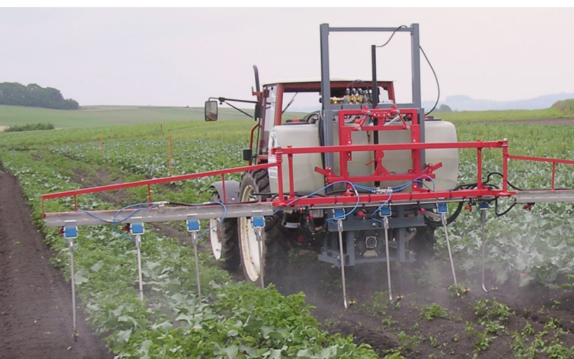
Les droplegs permettent de traiter la face inférieure des feuilles, où certains ravageurs comme les pucerons aiment se réfugier.
