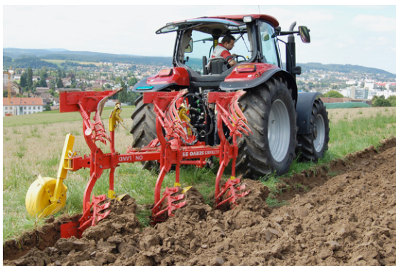
Der Onland-Pflug verhindert die Bodenverdichtung in der Pflugssole.
