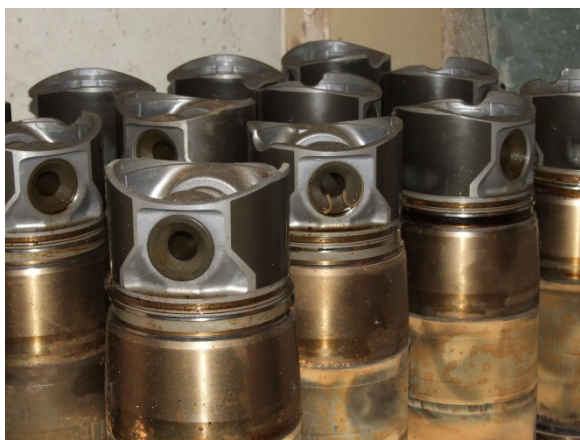
Rys. 28: Zasadnicze znaczenie dla niezawodnego działania mają regularne remonty jednostki CHP. Na zdjęciu: tłoki cylindrowe silnika. Zdjęcie: F. Gerlach, MEP.
