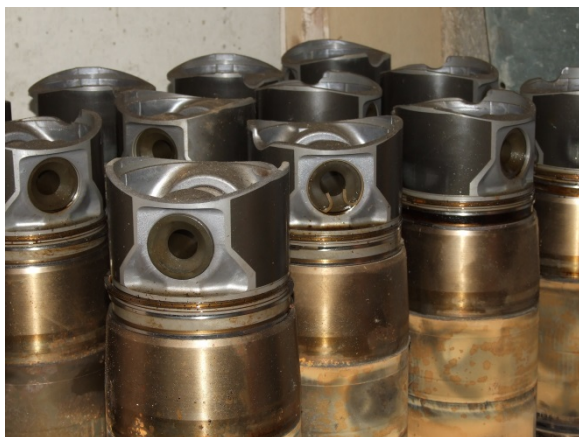
Фигура 28: Жизненоважно за надеждно функциониране е редовния ремонт на когенератора. На снимката: Бутала на цилиндричен двигател. Снимка: F. Gerlach, MEP.
