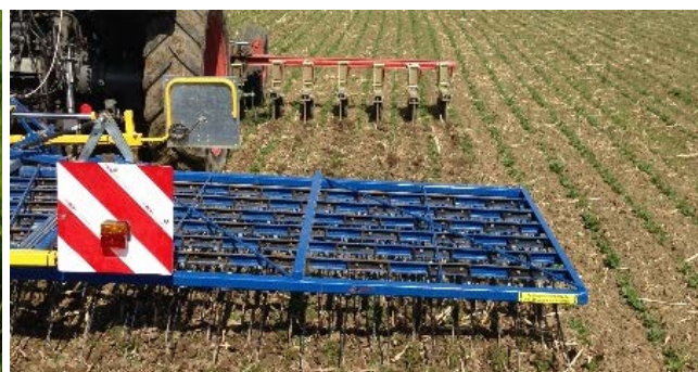
Foto 1: Weite Reihe, hier bei Gerste (Foto: Hansueli Dierauer, FiBL). Foto 2: Kombination 6 m Hacke (vorne) mit Striegel (hinten), hier in Soja (Foto: Ueli Weidmann, FiBL).
